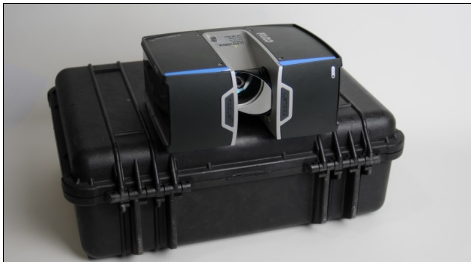
図 9-12: ミラーモジュールを外に向けてレーザースキャナを倒して寝かせた状態の輸送用ボックス
