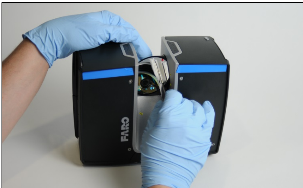
図 9-9: パッドとイソプロピルアルコールまたは洗浄液によるミラーモジュールのクリーニング
