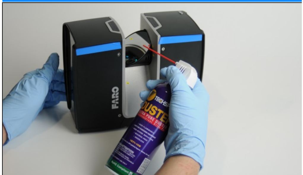
図 9-11: 圧縮空気またはダスタークリーニングスプレーによるドライブリクリーニング
