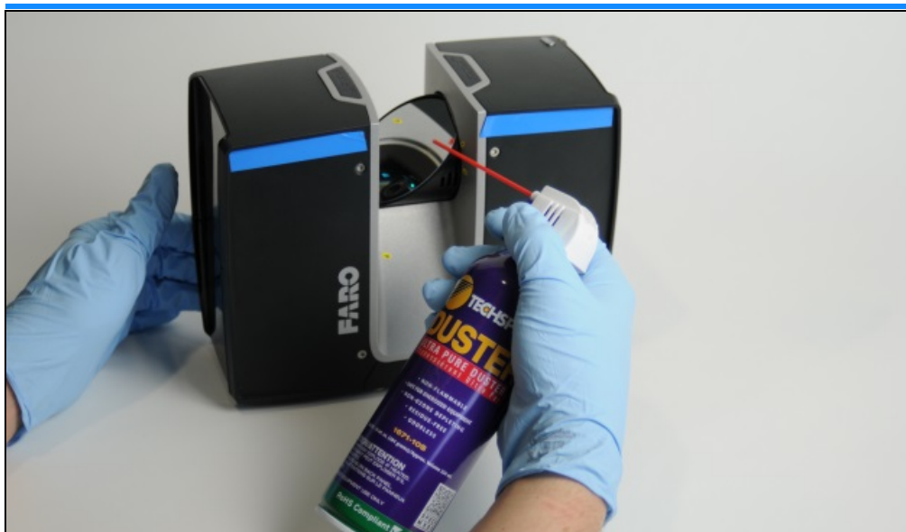
図 9-1: 圧縮空気またはダスタークリーニングスプレーによるドライブリクリーニング
